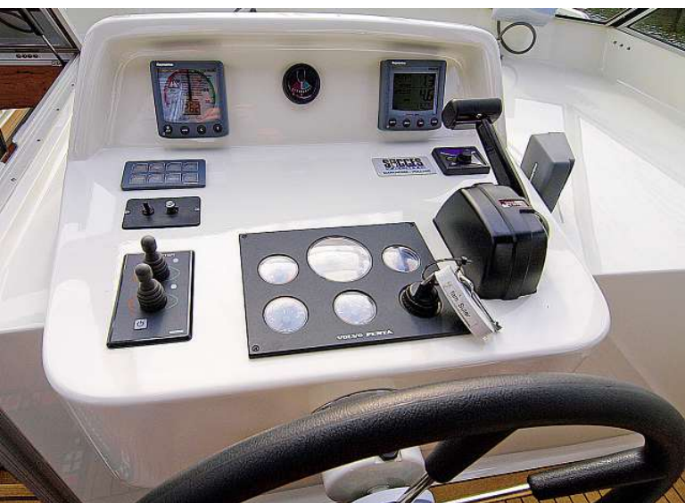
Die Konsole am Steuerstand ist als Modul aus GFK gefertigt
